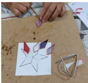
カットされたガラスを組み合わせ、ハンダ付け作業
