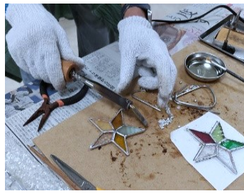
カットされたガラスを組み合わせ、ハンダ付け作業
